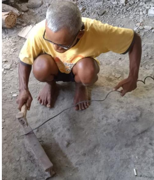
Gambar 7. Proses Pelurusan Bahan Peer Shock Motor Bekas (foto: Qorib, 2023)
