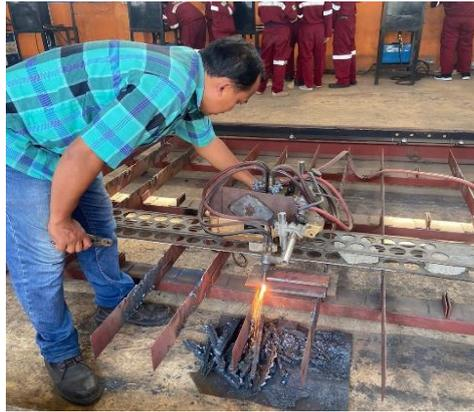
Gambar 2. Proses pemotongan Baja ST41
