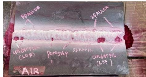
Gambar 5. Hasil *Liquid Penetrant Test* pada Pendingin Air
