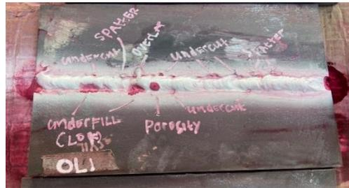
Gambar 7. Hasil *Liquid Penetrant Test* pada Pendingin Oli
