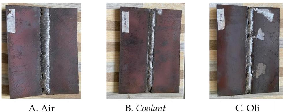
Gambar 4. Hasil pengelasan A, B, dan C
