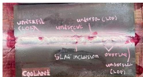
Gambar 6. Hasil *Liquid Penetrant Test* pada pendingin coolant
