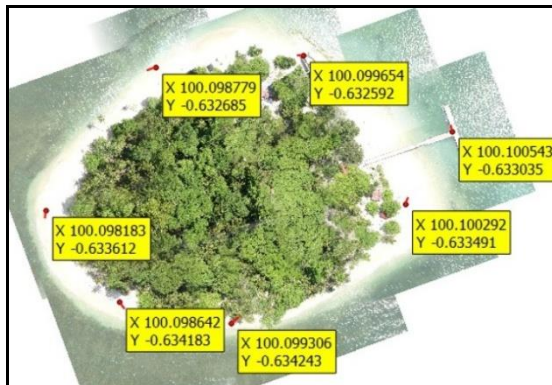
Gambar 4. Koreksi Geometrik Foto Udara
