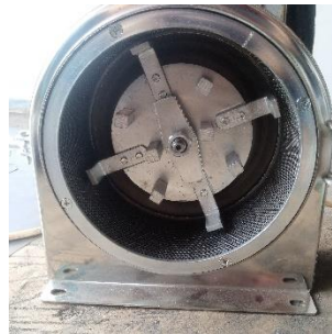
Gambar 8. Proses Pemasangan Ruang Penggiling Pada Rangka
