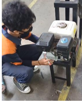
Gambar 4. Pemasangan Dudukan Motor Penggerak
