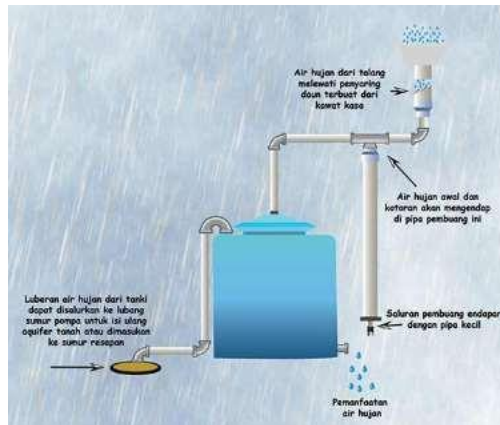
Gambar 4. Proses Pemanen Air Sederhana (Joleha *, 2019)
